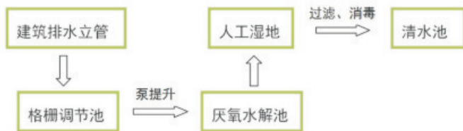
图3-7人工湿地工艺流程示意图
