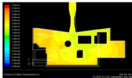
图4 首层水平面人行高度处温度分布图
