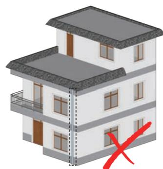
给排水管安装在建筑正面，影响住房建筑风貌
