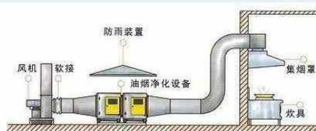
图NT4-2 厨房排风系统（室外安装） 图片来源：
