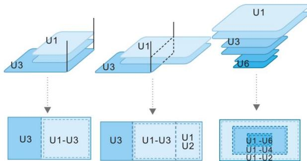
图 8.3.12-1 地下建（构）筑多层表示方式举例
