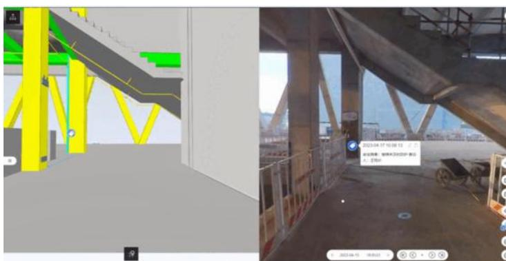
图 4-16 实体与模型反向定位管理
