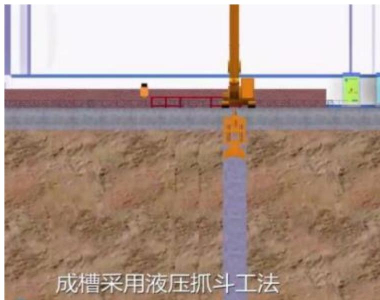
地下连续墙施工示意图
