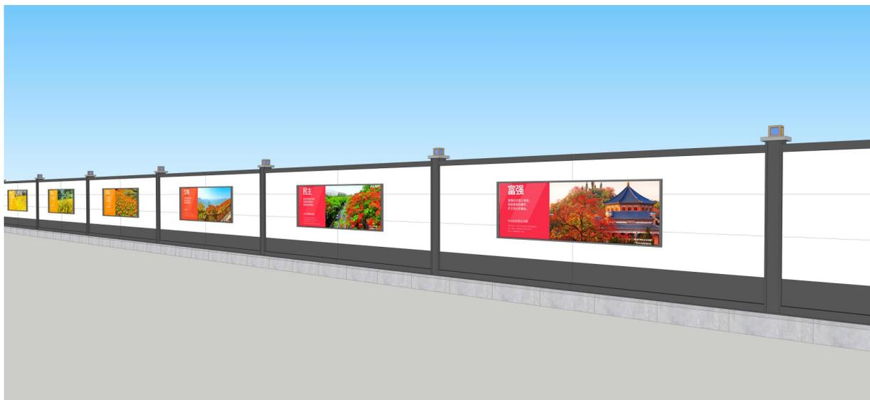
装配式钢结构围挡效果图（烤漆板）
