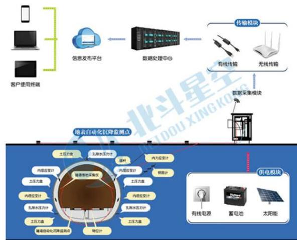
地下暗挖隧道自动化监测系统
