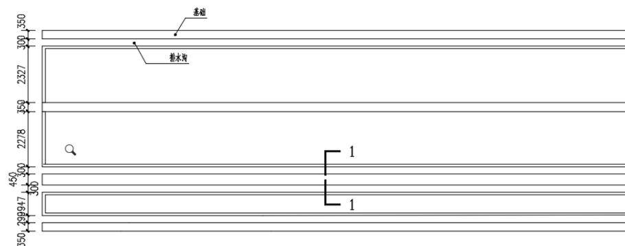
模块化箱房基础平面图
