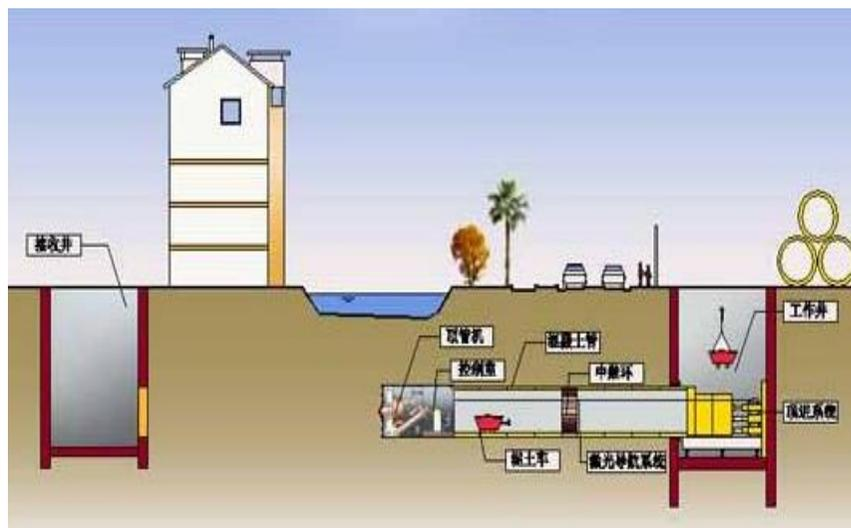
顶管施工示意图
