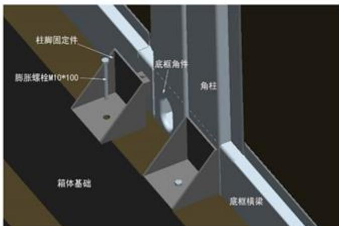
模块化箱房与基础连接示意图
