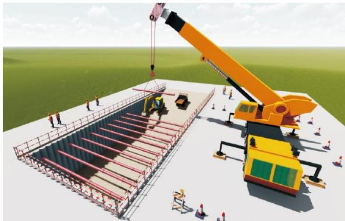
汽车起重机吊装示意图
