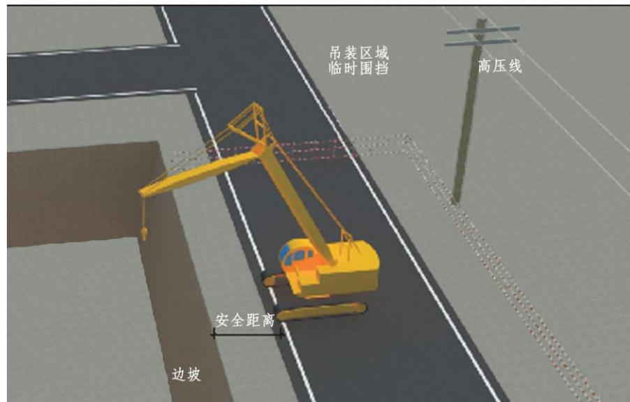
履带式起重机吊装示意图
