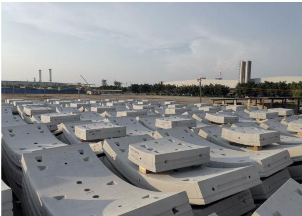
南沙分公司预制管片生产场地
