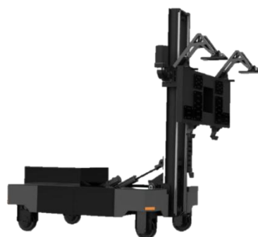
条板安装机器人
