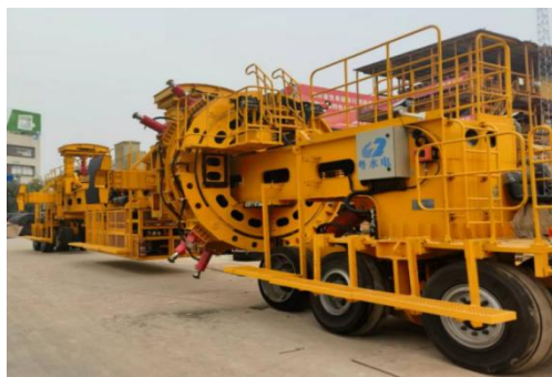
一种圆断面隧洞内衬钢管智能安装装备（台车）
