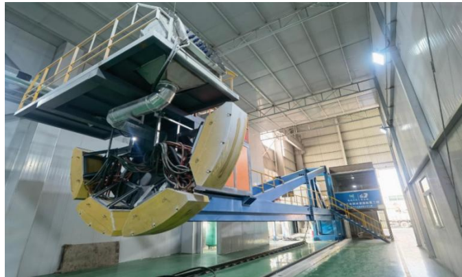
大直径钢管中频感应熔结环氧粉末喷涂成套装备
