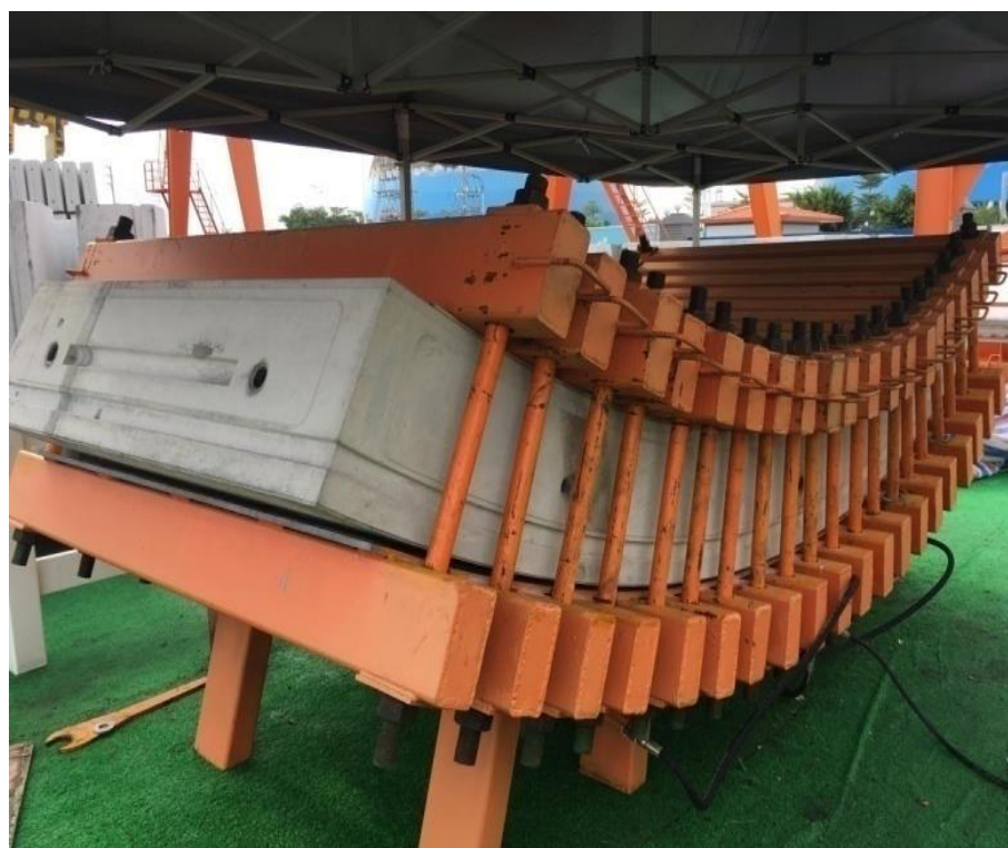
预制管片试验装置
