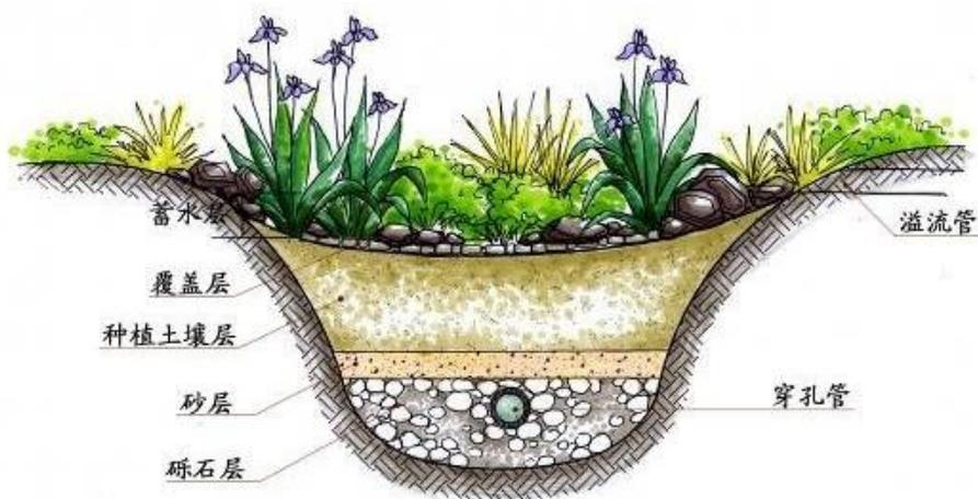
图 2.3 下凹式绿地构成
